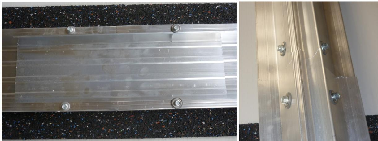
Abbildung 120: Verbinder Grundschiene und Verbinder Basisprofil in eingebautem Zustand
