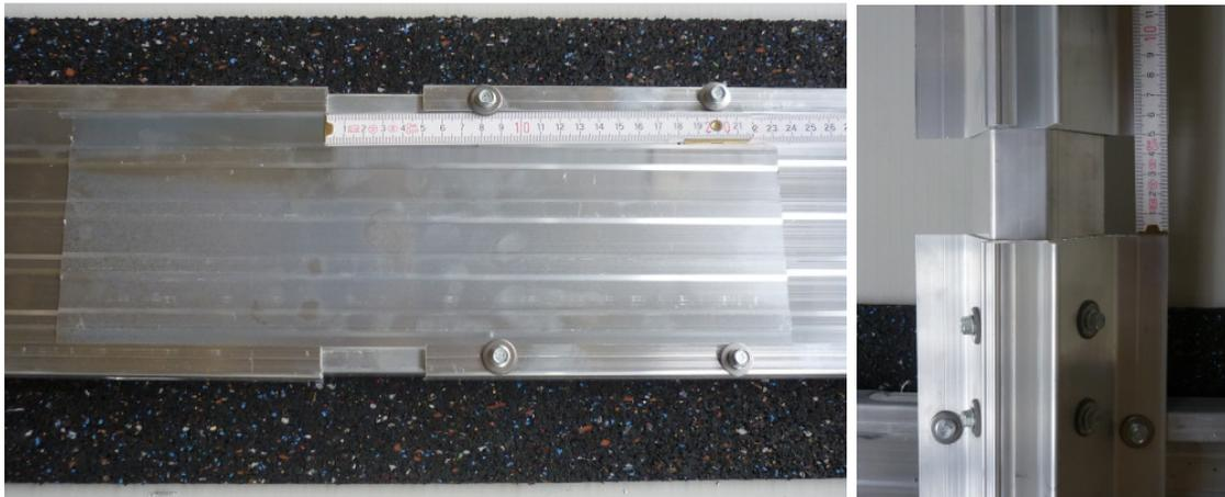
Abbildung 121: Dehnfugenausbildung durch Loslager: Grundschiene (links) und Basisprofil (rechts)
