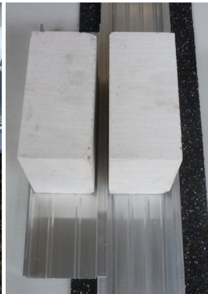
Abbildung 132: Ballastverteilung: auf Grundschiene (links) oder über die Ballastwanne (rechts)
