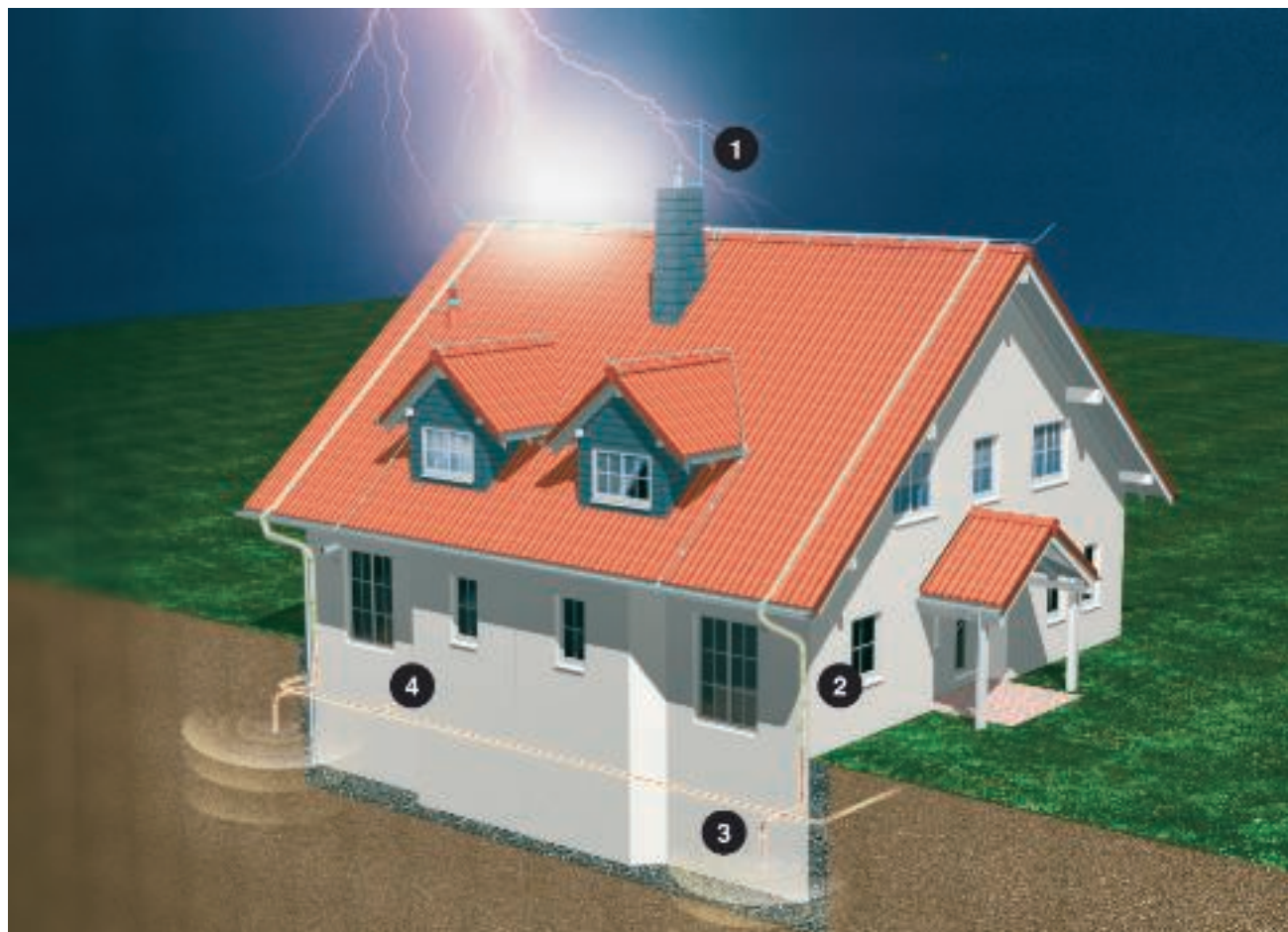
1 = felfogó, 2 = levezető, 3 = földelő, 4 = potenciál-kiegyenlítés (EPH)
