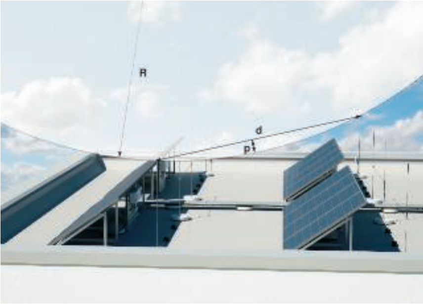
1. ábra: Szerkesztés gördülőgömbbel: gördülőgömb-sugár ( R ), a gördülőgömb belógása ( p ) a felfogórudak átlós távolsága ( d )
